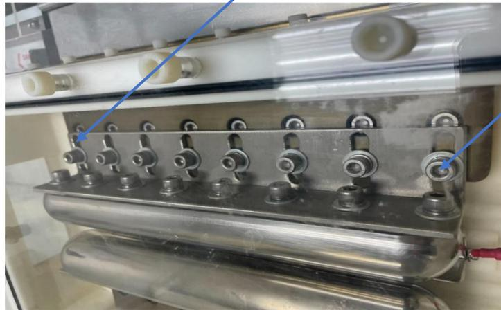
圖 3-7：半圓形電極與軌道間隙開關下方利用接著的是 L 形金屬板相連，L 形金屬板較長的部分與下方相連，較短的部分接半圓柱電極。
